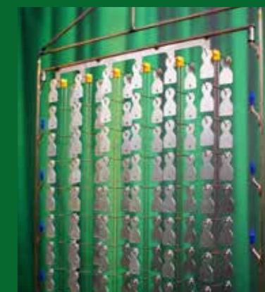
HCL HQW D patro v rámu - oboustranné zavěšení.
