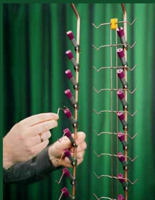
40 háčků vs. 1 HQW D se 40 závěsnými body
